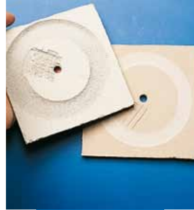
Taber aşınması uygulanmış Ultraplan (sağdaki örnek) ve normal tesviye şapı (soldaki örnek) - 200 devir sonra
