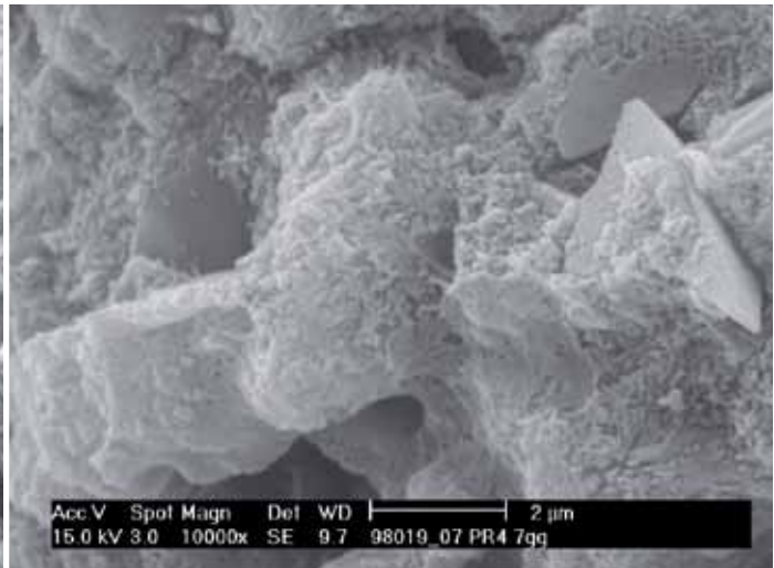
FOTOĞRAF 4 - 8 gün "yaşlandırıldıktan" sonra MAPE-ANTIQUÉ harcının mikro grafiği. Stabil bir sistemin tipik özelliği olan yuvarlak hatlı yapıya dikkat edin
